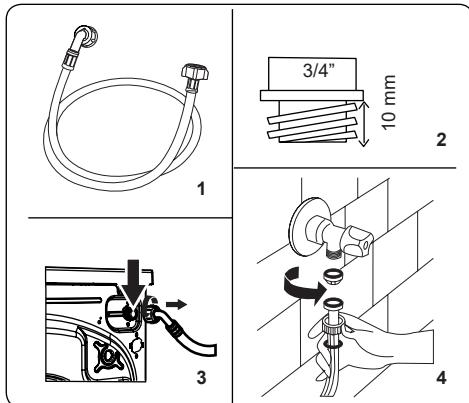
1. V závislosti na specifikacích pračky může být Vaše pračka připojena k přívodu studené vody nebo studené a teplé vody. Hadice s bílým uzávěrem by měla být připojena k přívodu studené vody a hadice s červeným uzávěrem k přívodu horké vody (pokud je k dispozici).
