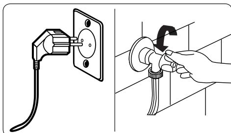
Před prováděním údržby a čištění pračky vypněte síťové napájení a vytáhněte zástrčku ze zásuvky.
