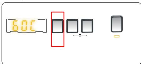
Když vyberete program, automaticky se vybere maximální teplota pro tento program. Chcete-li teplotu změnit, stiskněte tlačítko pro nastavení teploty vody, dokud se na digitálním displeji nezobrazí požadovaná teplota.
