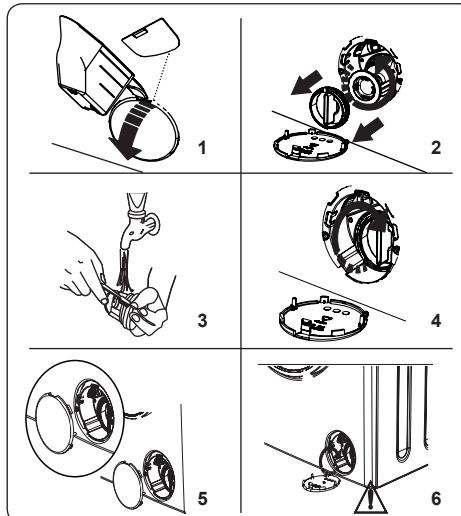
Filtráční systém čerpadla ve Vaší pračce prodlužuje životnost čerpadla tím, že zabraňuje vniknutí nečistot do pračky. Doporučujeme čistit filtr čerpadla každě 2 měsíce.
