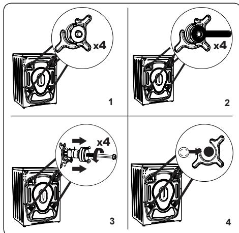
1. Než pračku uvedete do provozu, odstraňte z její zadní části 4 přepravní šrouby a pryžové podložky. Pokud šrouby nebudou odstraněny, mohou způsobit silné vibrace, hluk a nesprávnou funkci pračky a způsobit zrušení záruky.
