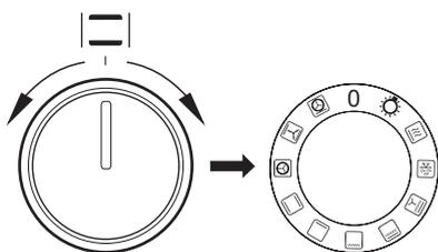
a pomocou otočného gombíka regulácie teploty – nastavenie sa vykonáva otočením gombíka do polohy so zvolenou teplotou.
